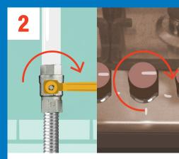
Закройте вентили на газопроводах и краны на приборах
